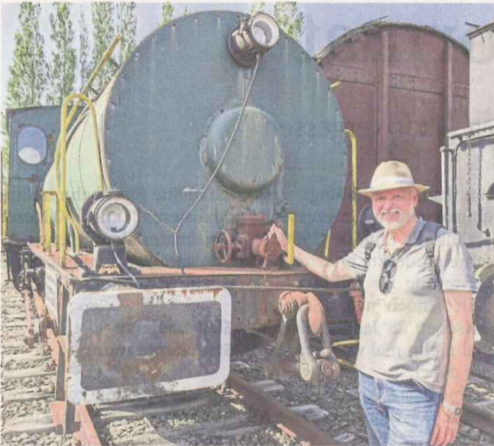
Michael Hanfstängl steht vor einer Dampfspeicherlok. Sie wurde in explosionsgefährdeten Industriebetrieben eingesetzt.
