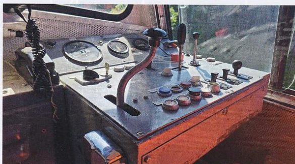
Hier wird noch von Hand gefahren: das analoge Führungspult der 512 010-0.
